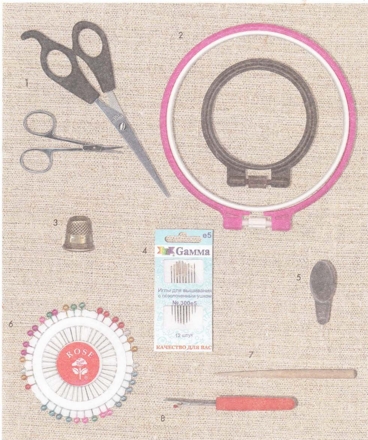
Рис. 4. Инструменты для вышивки: 1 — ножницы; 2 — пяльцы (диаметр 80 мм и 160 мм); 3 — наперсток; 4 — иглы; 5 — нитковдеватель; 6 — булавки; 7 — дырокол; 8 — поротель
