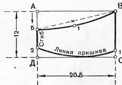
Рис. 254. Чертеж выкройки воротника № 13.
