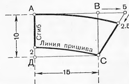
Рис. 296. Чертеж выкройки манжеты № 6.
