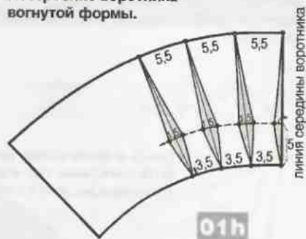
Построение воротника вогнутой формы.
