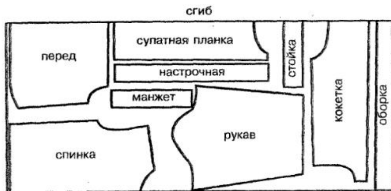
Рис. 39. Раскладка лекал на ткани для блузы с плиссированной кокеткой
