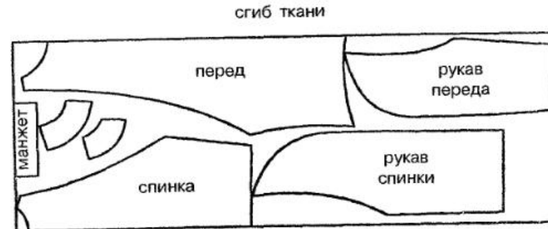
Рис. 175. План раскладки лекал на ткани для блузы «нулевой реглан» с драпировкой типа «качели»
