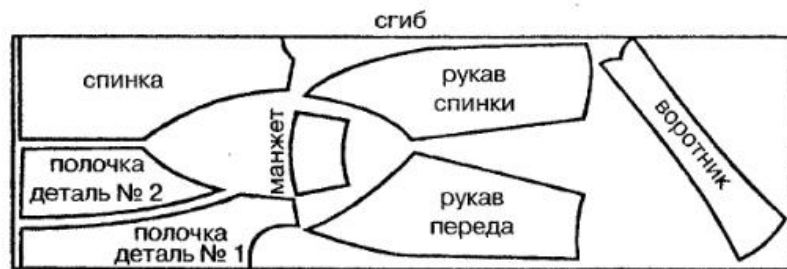
Рис. 157. План раскладки лекал на ткани для блузы «нулевой реглан» с отделочным воротником
