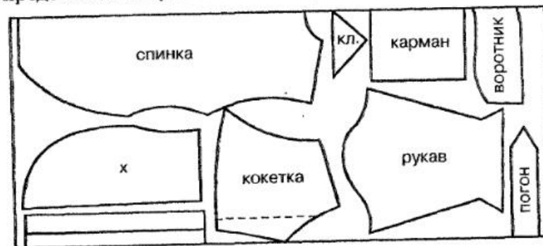
Рис. 66. Раскладка лекал на ткани для рубашки в полоску
