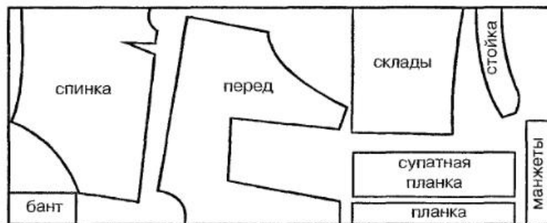
Рис. 121. Раскладка лекал на ткани для блузы с подрезными складками
