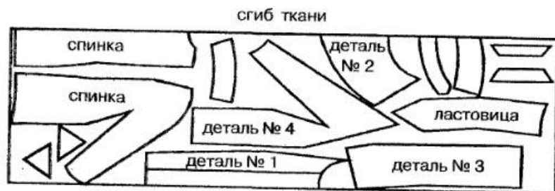
Рис. 146. Раскладка лекал на ткани для блузы удлиненной спортивного типа
