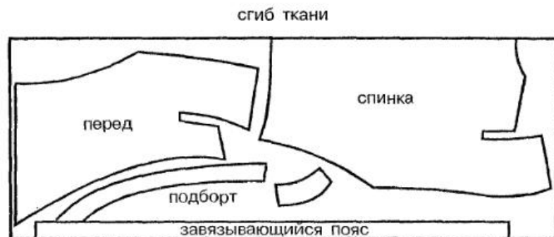
Рис. 113. Раскладка лекал на ткани для «японки», выполненной в виде крылышек
