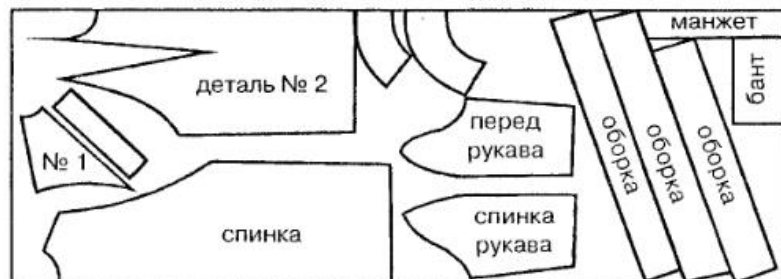
Рис. 200. План раскладки лекал на ткани для блузы «полуреглан» с отделкой типа жабо
