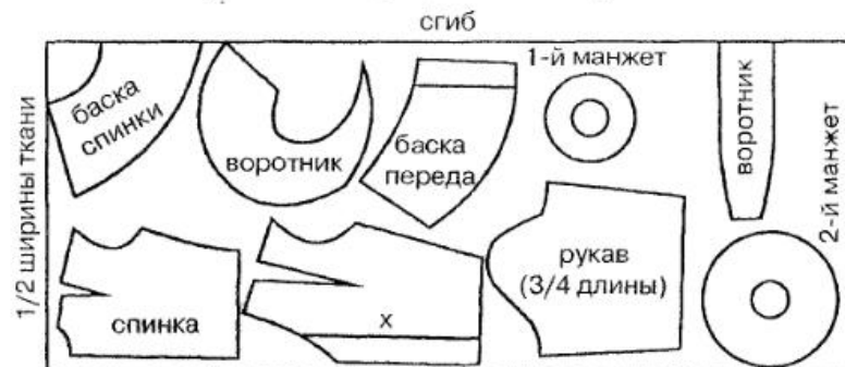
Рис. 12. План раскладки лекал на ткани на блузу с шалевым воротником
