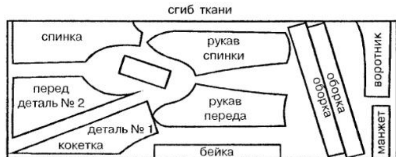
Рис. 168. План раскладки лекал на ткани для блузы со вставкой из гипюра
