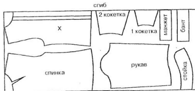
Рис. 18. План раскладки на ткани для блузы с отлетными кокетками
