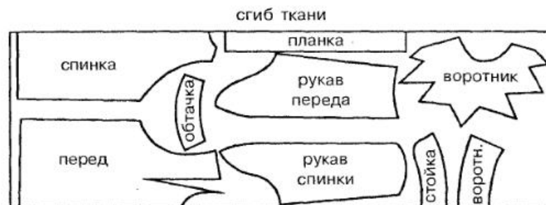
Рис. 189. План раскладки лекал на ткани для блузы с отлетным воротником типа «звезда»
