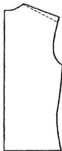
Рис. 204. Исправление косых заломов до проймы
