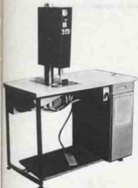
Ультразвуковая установка для сварки швов тканей американской фирмы „BRANSON“
