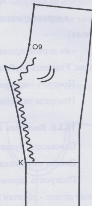
Рис. 16.6. Схема оттяжек и сутюжек задней половины брюк
