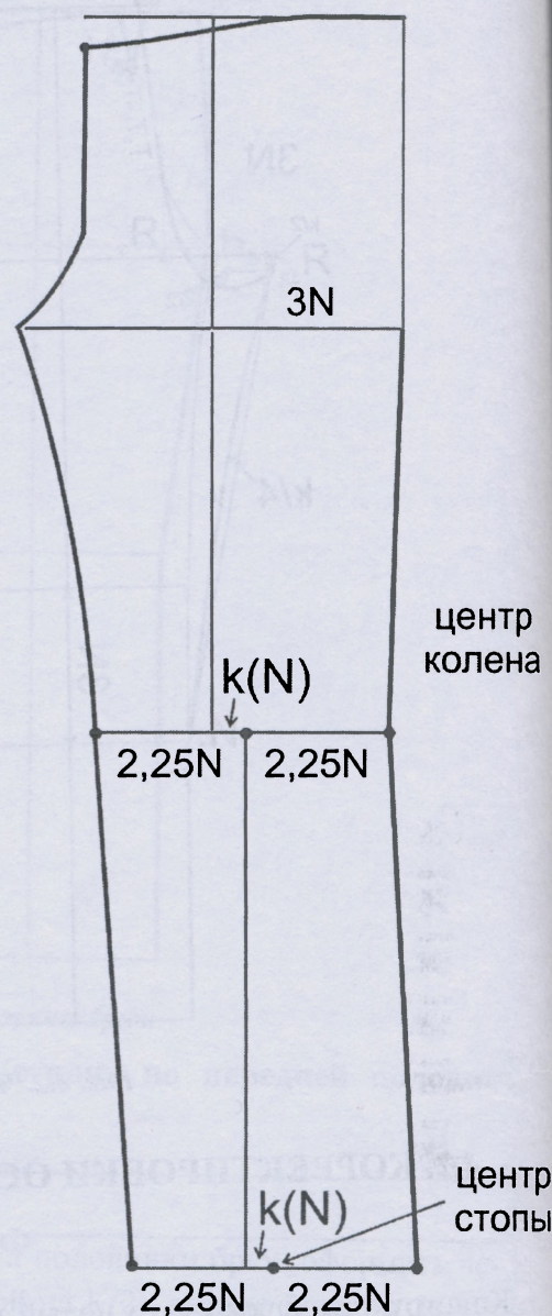
Рис. 4.3. Корректировка брюк на форму ноги
