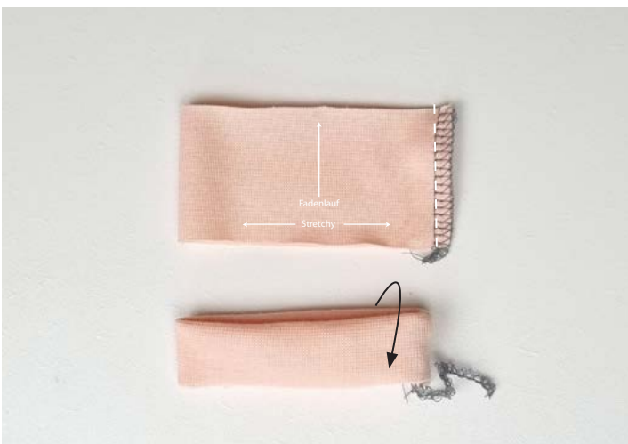
11. Die Ärmelbündchen rechts auf rechts mittig falten und die Seitennaht schließen. Dann ineinanderstülpen.
