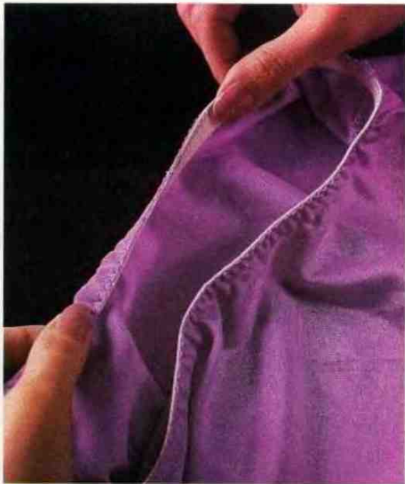
5. Подогните край на изнаночную сторону вместе с резинкой.
