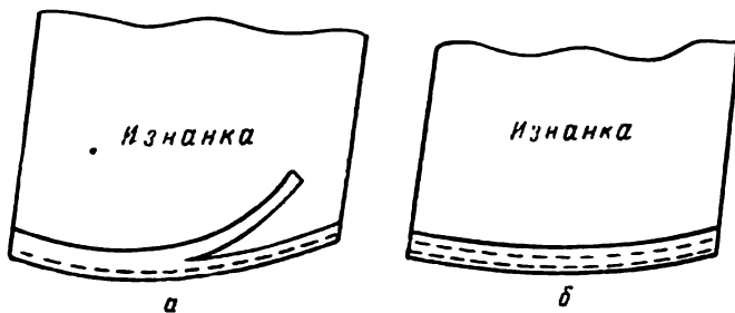
Рис. 13. Узкий шов вподгибку с двойной строчкой: а — выполнение первой строчки и подрезка края; б — выполнение второй строчки
