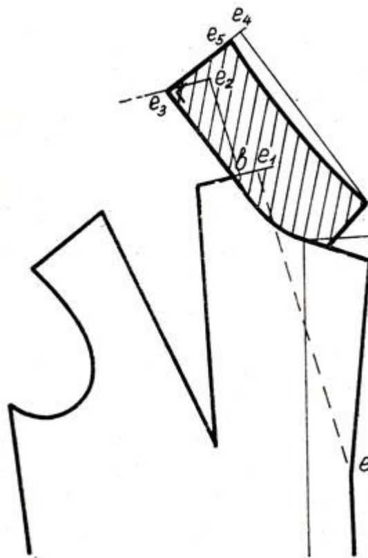
Рис. 53. Чертеж отложного, открытого воротника
