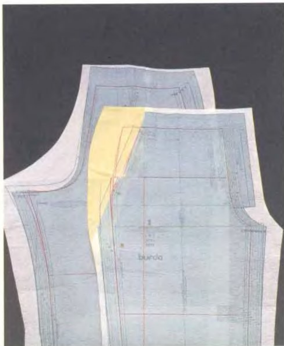
3) Добавьте 3,8 см на передней линии среднего шва для застежки-молнии и по 1,5 см к средним швам на передней и задней половинках выкройки, а также к линии входа кармана с подкройным бочком.
