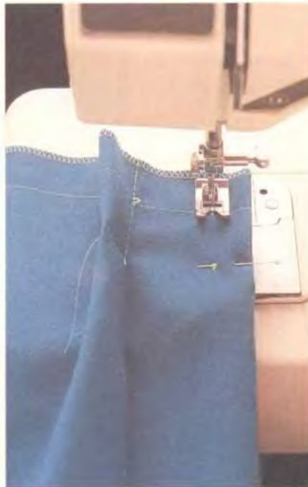
5) Совместите метки складки, сложив ткань лицевой стороной внутрь. Сделайте машинную наметку по меткам. Слегка заглаьте в направлении, указанном на выкройке.
