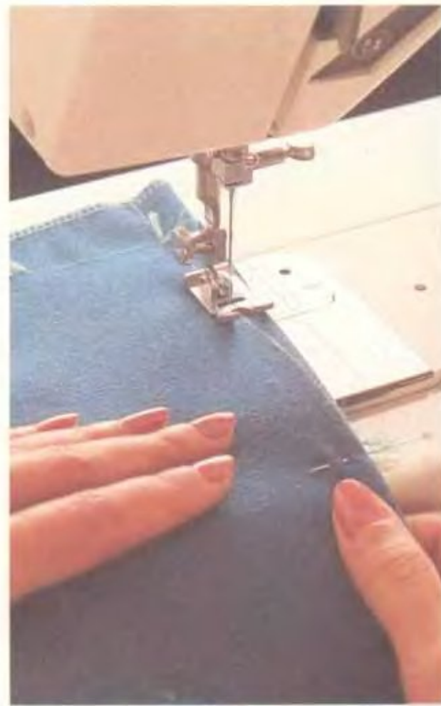
3) Заложите выгачки, сложив ткань лицевыми сторонами внутрь так, чтобы совпали метки. С помощью линейки проведите линию от острия выгачки к метке на линии талии. Согните выгачку по центру; стачайте; слегка заутюжьте на гладильной подушечке.
