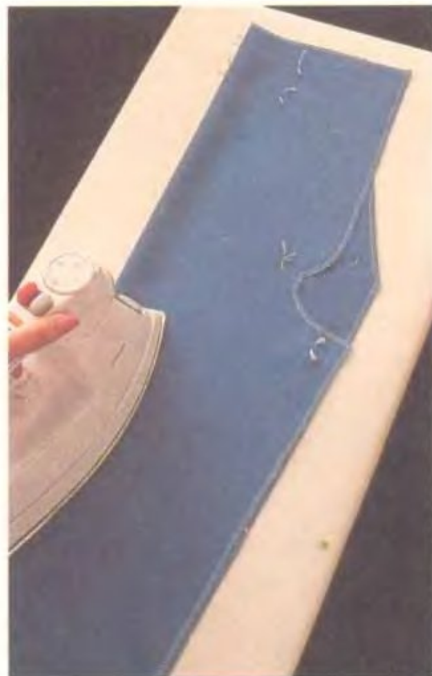
4) Сложите переднюю часть брюк по средней долевой линии так, чтобы совпали шаговый и боковой швы от нижнего края до области колена. Слегка проутюжьте по линии стрелки до линии сидения для брюк с выгачками и до талии для брюк со складками.
