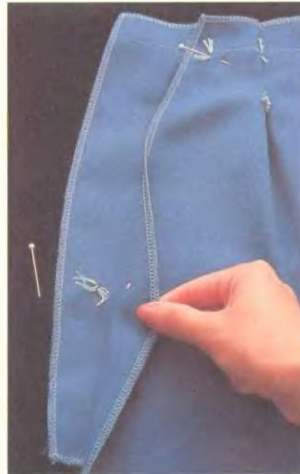
6) Наложите линию шва детали бокового кармана с подкройным бочком, совместив метки на обоих концах шва. Сметайте на машине по линии шва. (Если фасоном предусмотрен карман в боковом шве, не притачивайте его до первой примерки.)
