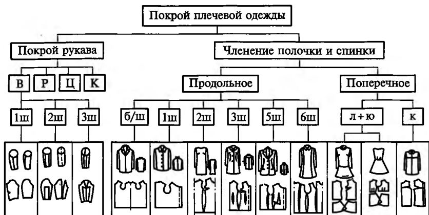
Рис. 1.4. Схема членения поверхности деталей плечевой одежды
