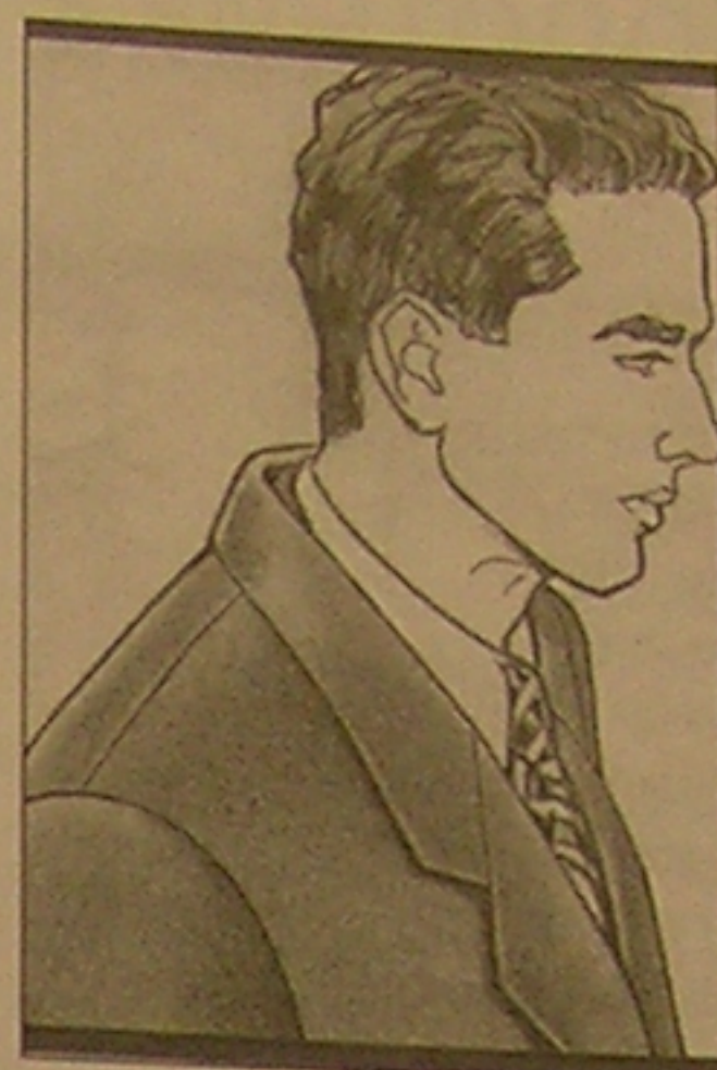
Илл. 2. Сзади воротник отстоит от шеи. Этот дефект вызван неправильным углом наклона линии плеча переда и спинки и тем, что воротник не оттянут по краю отлета.
