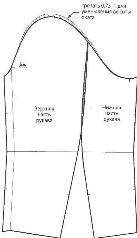
Илл. 3. Рукав по линии оката укоротить в области локтевых линий.
