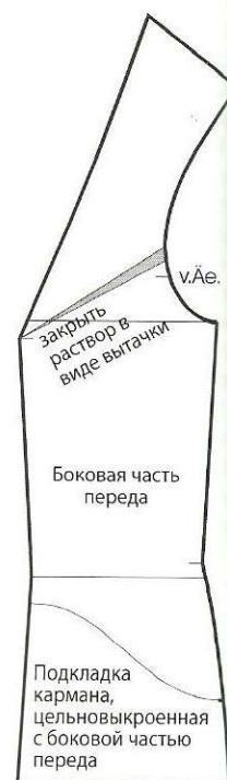
Илл. 2. Укорачивание проймы путем закрытия раствора в виде вытачки величиной 1 см.
