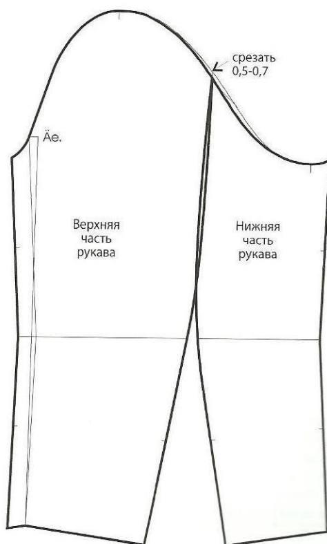
Илл. 3. Изменение чертежа верхней и нижней частей рукава. Линию оката нижней части рукава следует адаптировать к пройме.
