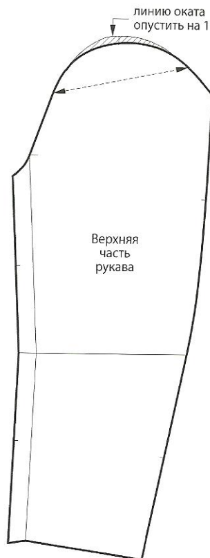
Илл. 5. Изменение чертежа рукава: укорачивание и расширение оката.
