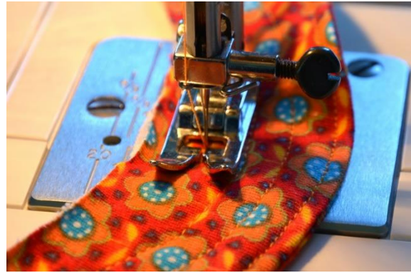
14. Parallel zur Absteppnaht mehrere Steppnähte aufnähen, die dem Schirmchen Stabilität verleihen. Dabei das Füßchen als Abstandshalter und Führungslinie nutzen.
