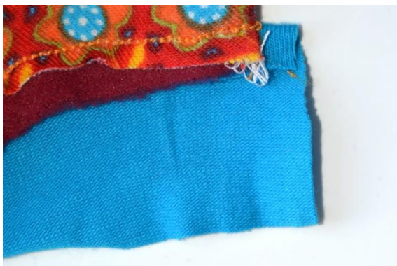
34. Den Bündchenstreifen nach unten klappen. Die Nahtzugabe liegt auf der linken Seite des Bündchenstreifens.
