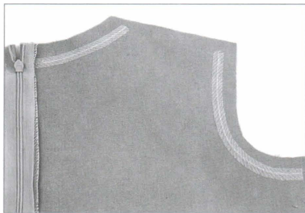
Укрепление срезов изделия клеевой кромкой
