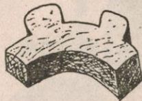
для разутюживания плечевых швов и шва втачивания воротника
