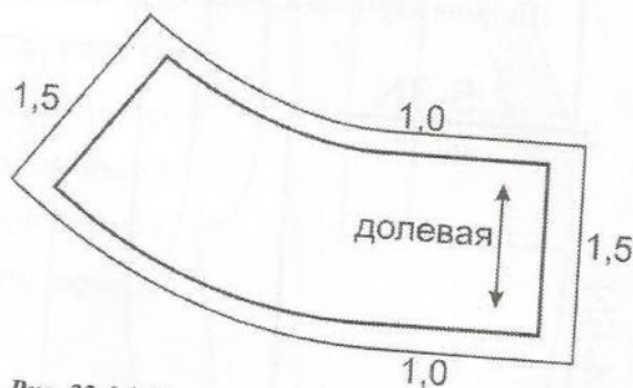
Рис. 22.6.1. Выкройка обтачки на основе лекала юбки
